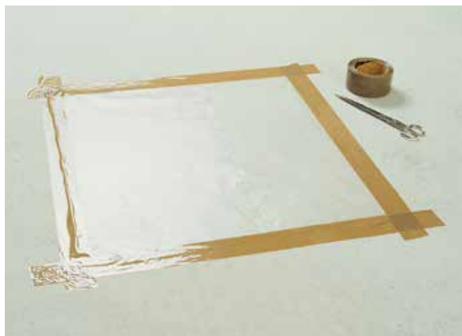
Grafika 44: Wstępne badanie schnięcia przy użyciu folii na podkładzie grzewczym
