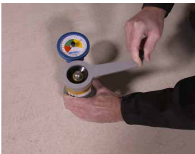
Grafika 51: Badanie wytrzymałości na odrywanie
