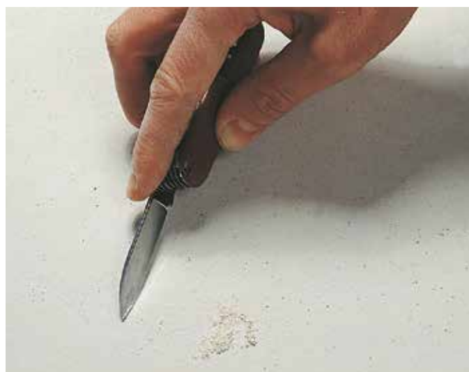
Grafika 49: Badanie struktury rozkładu kruszywa
