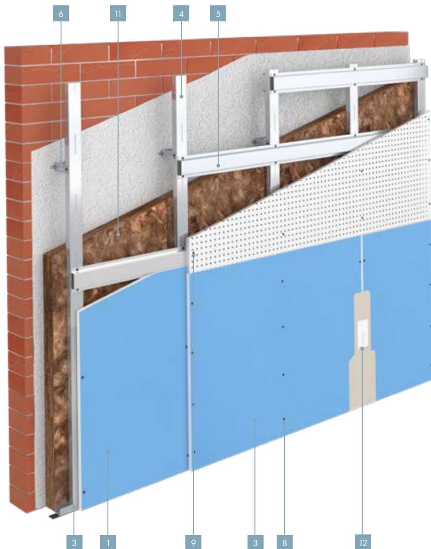
W623D – Przedścianka z okładziną z płyt perforowanych Cleaneo Akustik, profile CD i profile kapeluszowe
