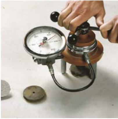
Badanie wytrzymałości powierzchniowej na rozciąganie, tzw. „pull off”
